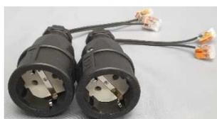
optionale Adapter zur Prüfung der Phasenverteilung
